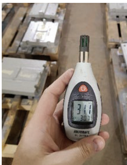
Slika 17 • Kontrola temperature in vlažnosti v barvalni komori.
