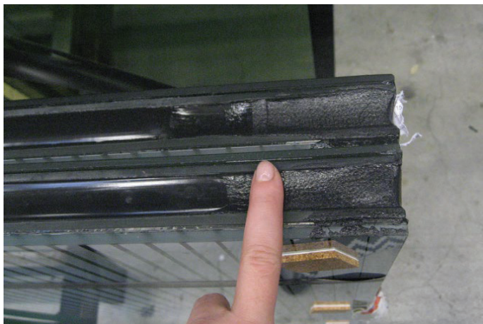
Slika 11 • Izolacijsko steklo – uporabljen adheziv silikon; lepljeno lamelirano steklo, ki je v uporabi kot konstrukcijsko steklo – adheziv PVB-folija.
