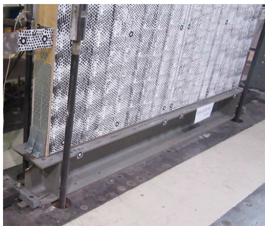
Slika 3 • Detalj pritrditve preskušancev z dviznimi kotniki (levo) in vijachenimi spoji spodnje prečke okvirja preko pasnice jeklenega profila (sredina), vpetje panela B12-16/75x1/M z močnejšima dviznim kotnikoma ob straneh in strižnimi kotniki na enakomernih razdaljah vzdolž ene strani panela (desno).
