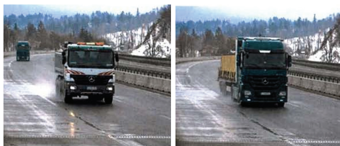
Slika 6. Kalibracijski vozili: levo, 3-osno vozilo; desno, 5-osno vozilo 113 [Žnidarič, 2018].
