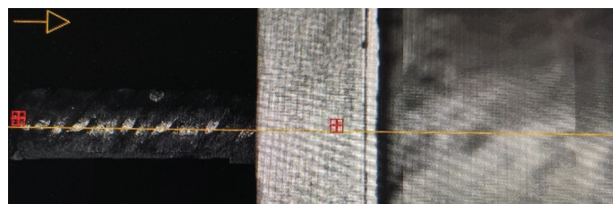
Slika 5. Prikaz referenčnih točk za merjenje zdrsa med betonskim preizkušancem in armaturno palico med izvedbo preizkusa.
