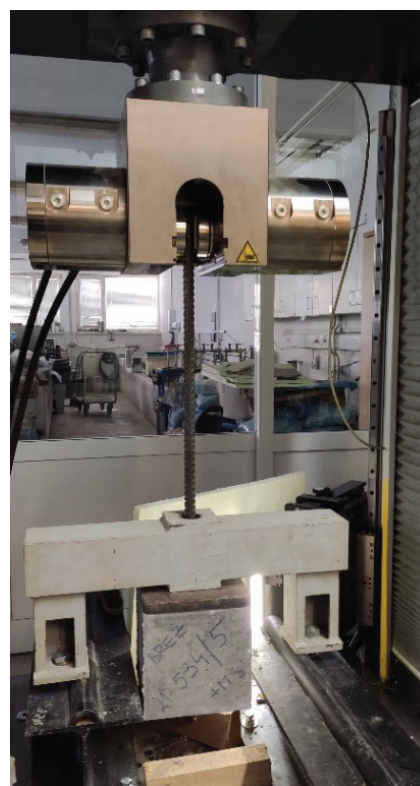
Slika 4. Prikaz preizkuševalne opreme in izvedbe preizkusa izvlečne sile F_{izvl}
