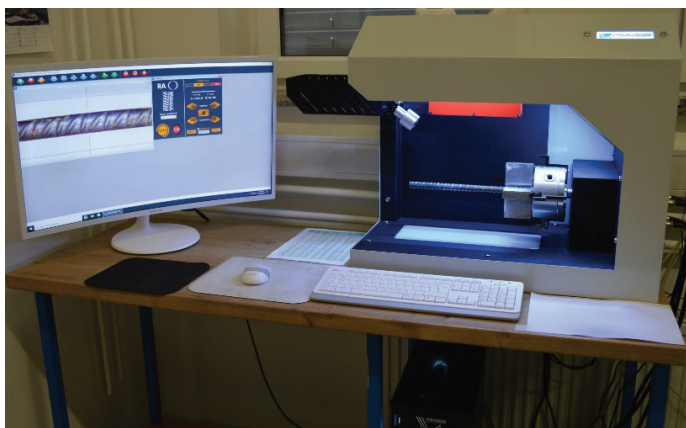
Slika 3. Določanje deleža reber na armaturnih palicah.
