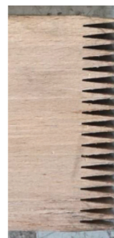
Slika 5. Rezkalni nož za 18 mm dolg zobati spoj (levo) in deska z 18 mm dolgim zobatim spojem (desno).
