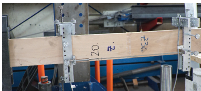
Slika 6. Laboratorijske meritve statičnega modula elastičnosti 18 mm dolgega zobatega spoja z LVDT-merilniki.
