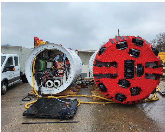
Sliki 6 in 7. Priprava vrtalne glave in separacije pred izvedbo mikrotunela.
