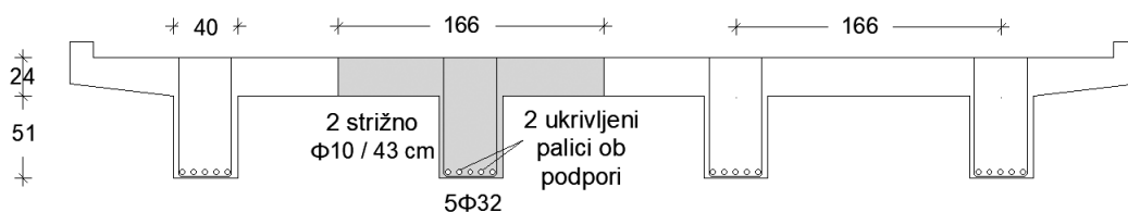
Slika 4. Idealiziran prerez prekladne konstrukcije z označeno armaturo. Dimenzije prereza so v [cm]
